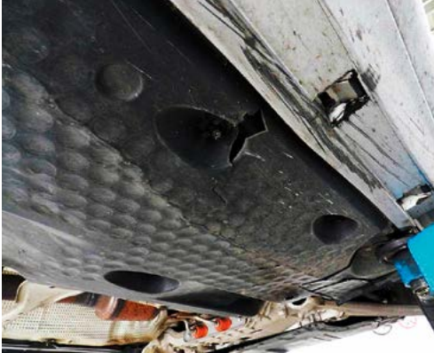
Domage de l'habillage du sous-plancher
