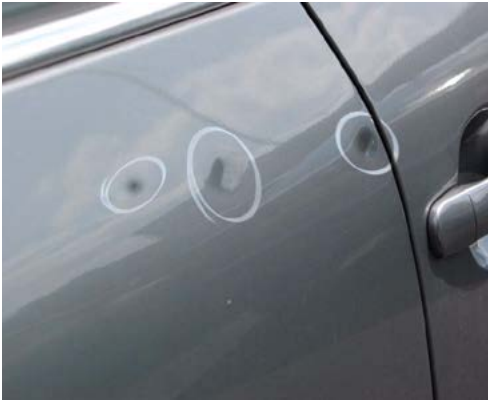
Impact creux sur une pièce de carrosserie
