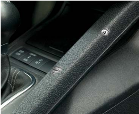
Trou de perçage dans l'habillage
