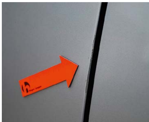
Dommages de peinture superficiels sur le bord de la portière
