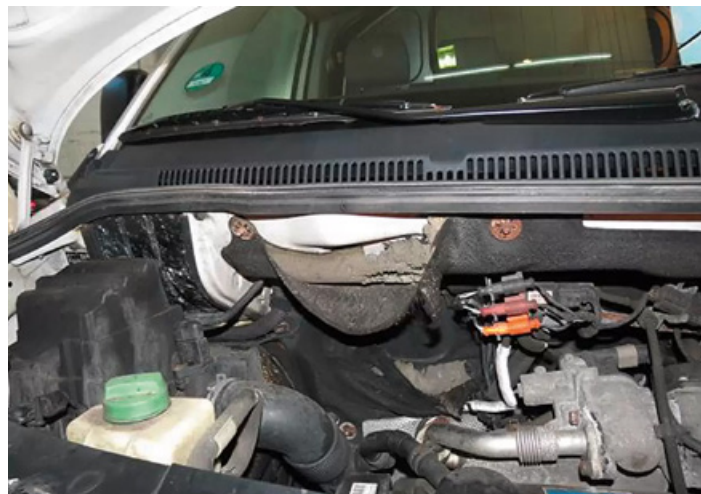
- Tapis isolant endommagé
