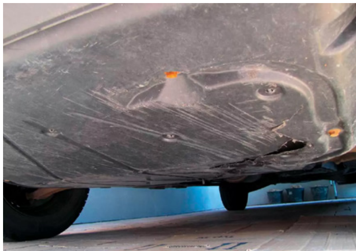
- Endommagement du revêtement de bas de caisse
