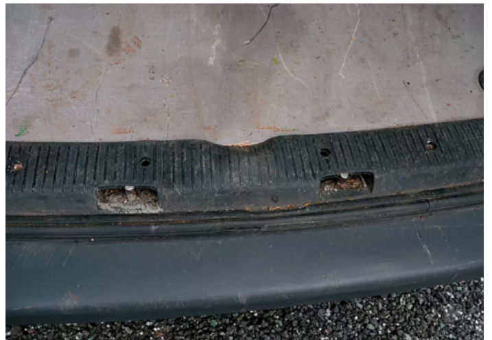
- Endommagement du seuil de chargement
